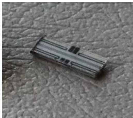
Рис 2. 1 ГГц ПАВ резонатор в полностью кварцевом корпусе А174-1000М1
